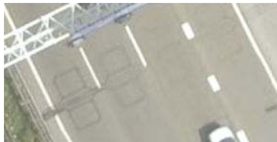
figuur 2-1 Detectielussen in de A13 richting Den Haag bij knooppunt Ypenburg. Bron foto: [6].
