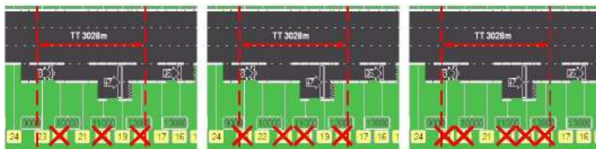
figuur 8-4 Detectoren die wordt vervangen bij S4-1 (links), S4-2 (midden) en S4-3 (rechts) bij het testen van de vervangende waarde van reistijdmetingen met traject 4.
