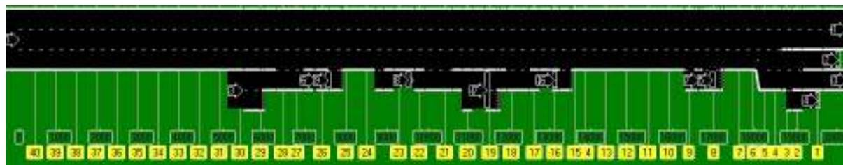
figuur 7-5 Locaties van de 40 dubbele detectielussen op de hoofdroute (A13) die gebruikt worden bij het testen vanaf Den Haag tot het Klein Polderplein.
