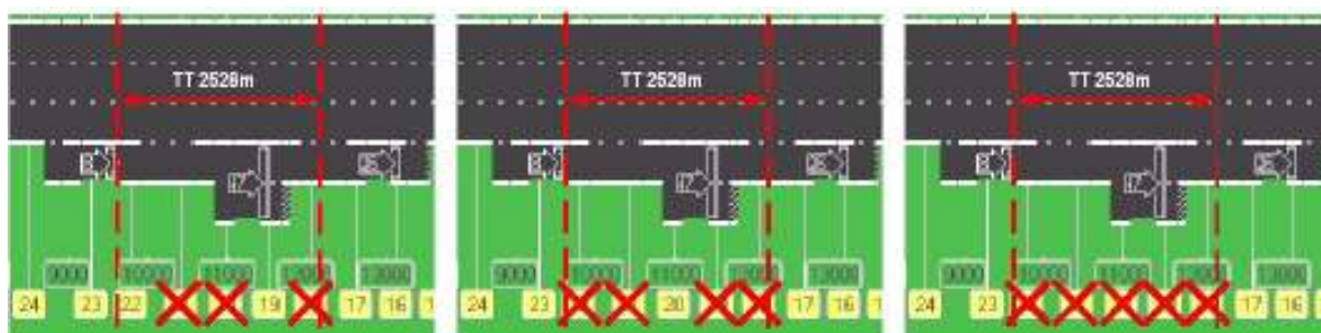
figuur 8-3 Detectoren die wordt vervangen bij S3-1 (links), S3-2 (midden) en S3-3 (rechts) bij het testen van de vervangende waarde van reistijdmetingen met traject 3.
